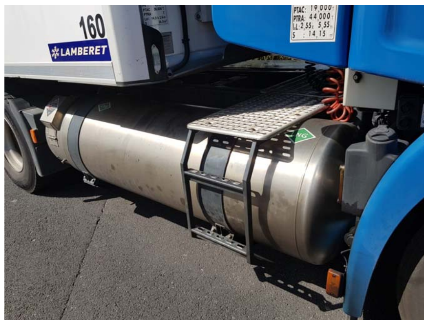
Abbildung 2: LNG-Tank (540L) von IVECO Fahrzeug (Quelle: eigene Aufnahme)
