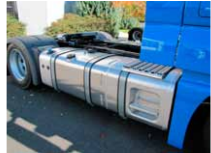
A vontatók egy 595 és egy 330 literes alumínium gázolajtartállyal rendelkeznek.
