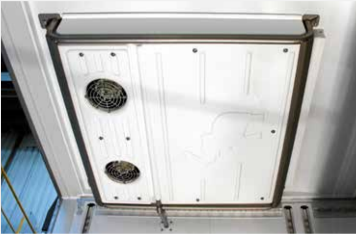
Der neue Deckenzusatzverdampfer erhöht die Flexibilität bei Kühltransporten.
